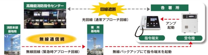
万一、高機能消防指令センターと各署所間の既設回線が切断されても、通信が可能となるようネットワークを二重化。
