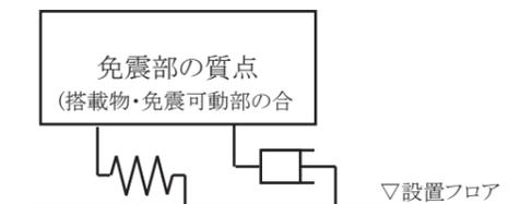
図10 免震部質点モデル
